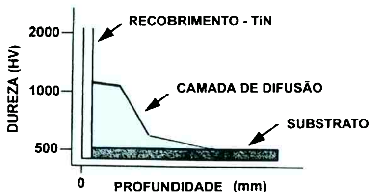
Figura 4 - Suporte mecânico para o filme TiN conferido por uma camada de nitretação iônica intermediária, entre o filme e o substrato (Franco Jr, 2003)
